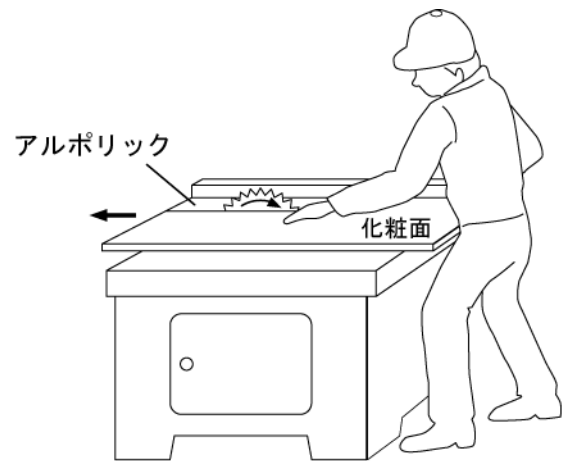
昇降盤によるアルポリックの切断要領
